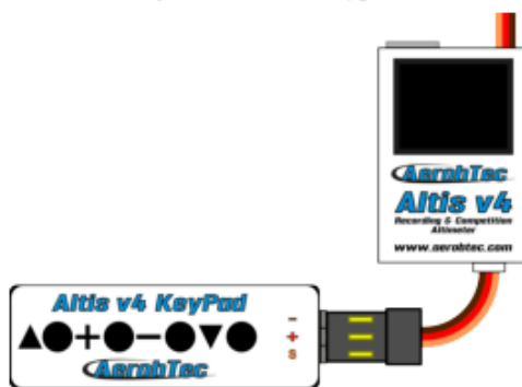
15. sz. ábra: Az Altis v4 billentyűzet csatlakozása
